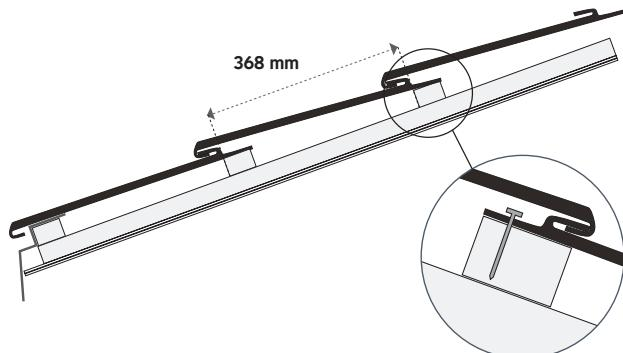
Panourile se montează pe rigle orizontale paralele dispuse la 368 mm.
